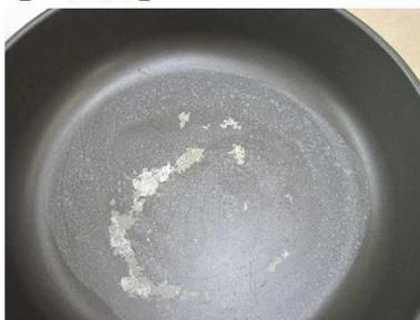
※上写真は洗浄が不十分で洗い残りの上にこびり付いた例です。細かいキズが多くなると油カス等がキズに固着し易く、こびり付きの原因となります。ご使用後は毎回、多めの中性洗剤で良く洗浄して下さい。汚れが原因のこびり付きは保証対象外です。
