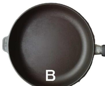
左のABの写真はいずれもコーティングが劣化して変色しており、高温(250°C以上)で使用された形跡が認められるものです。Aは茶色く変色しております。さらに劣化するとBの様に濃いこげ茶色となります。高温使用によるコーティングの劣化により、こびり付く場合は保証の対象外となります。ただしA程度の場合は変色の度合いによってテスト・判断させていただきます。
