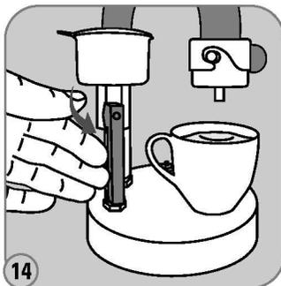
14 (G) バルブレバーをゆっくりと垂直にし、内部に残った高圧蒸気を吹き出します。これで抽出完了です。
